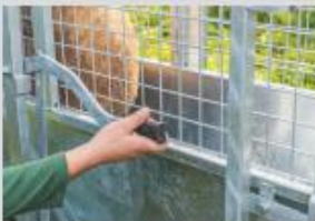
Leicht erreichbarer Hebelgriff für eine Aktivierung der Wiegefunktion
